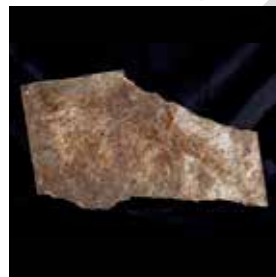
D2Y2:8 碳化硅耐火板，石油氣窯使用， 長59.2、厚2.5厘米
