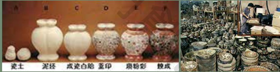
左：雙連瓶從製模、注漿、加彩到燒成的過程 右：1980年代華通陶瓷公司用鯉魚門白胎瓷進行加彩工序（資料來源：姚開麒）
