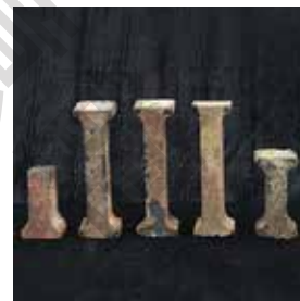
D2Y2:1,3-6 T型碳化硅耐火柱，石油氣窯使用， 長身柱：高24、闊6厘米； 矮身柱：高15、闊5.5厘米
