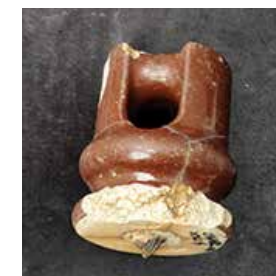
D1C1:3A 紅釉高壓電磁子， 殘高6.7厘米
